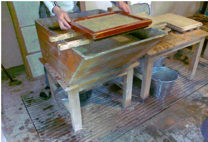
Abb. 3: Manuelle Papierherstellung, China 2016, Quelle: eigene Aufnahme, 2016
